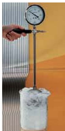
a) Termómetro de gas con volumen constante
