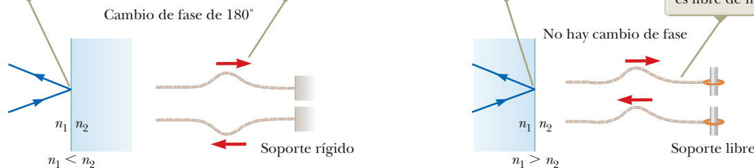
Figura 37.9 Comparaciones de las reflexiones de las ondas de luz y de las ondas en cuerdas.
