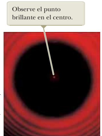
Figura 38.3 Patrón de difracción creado por la iluminación de una moneda colocada entre la pantalla y la fuente luminosa.
