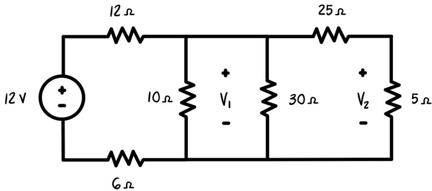
**Figura 2.** Circuito con 6 resistencias, y una fuente de 12 V.
