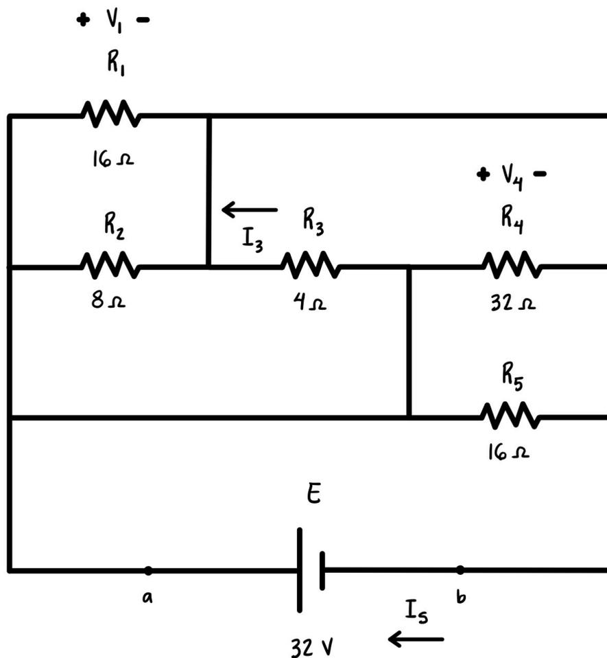
**Figura 3.** Circuito con 5 resistencias, y una fuente de 32 V.
