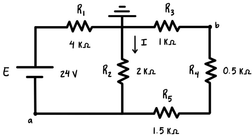
**Figura 4.** Circuito con 5 resistencias, y una fuente de 24 V.
