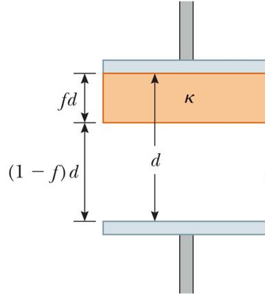
**Figura 2.** Condensador de placa paralela.
