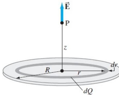
**Figura 1.** Disco de radio  $R$  con densidad de carga  $\sigma = Cr$ .
