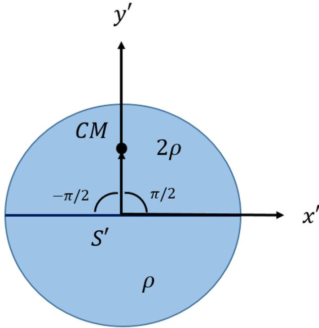
**Figura 8:** Inicialmente tendremos el disco con el hemisferio mas denso en la parte de arriba, por lo que el centro de masa estará desplazado en esa dirección.
