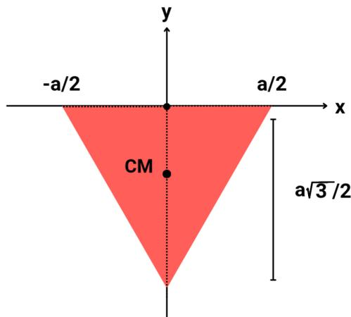
**Figura 2:** Para el primer caso tenemos un triángulo equilátero colgado de la parte media de uno de sus lados de longitud  $a$ .
