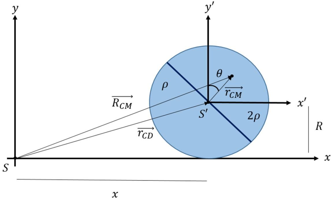
**Figura 7:** Tenemos un disco cuya densidad es distinta para cada hemisferio, lo que provoca que el centro de masa este en una posición distinta al centro geométrico del círculo.
